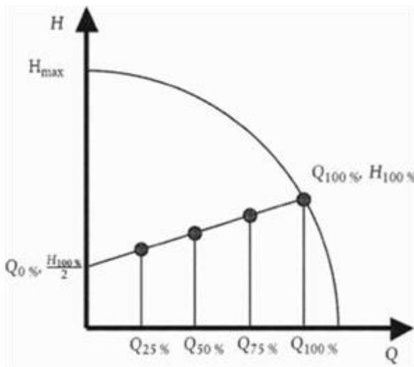
Рис. 1. Опорная контрольная линия циркуляционного насоса.
